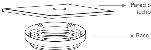
1- Acorde con la zona a monitorear, instale la base de la cámara amurada al techo o pared con tornillo de expansión.
