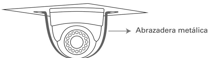
4 - Una vez instalada la cámara le sugerimos incluir abrazadera metálica como precaución anti robo.
