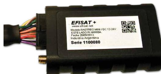
Debe estar ubicado permitiendo que la zona de la etiqueta quede hacia arriba tal como está marcado para buen funcionamiento del GPS.
