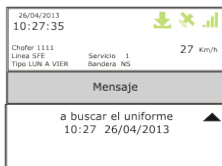
para volver a la pantalla de trabajo normal se presiona la tecla “+” que, como se explico anteriormente sirve para borrar el mensaje ya leído
